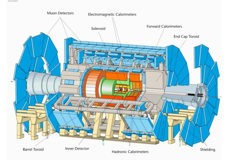
Length : 40 m Radius : 10 m Weight : 7000 tons Electronics channels : 10<sup>8</sup>
