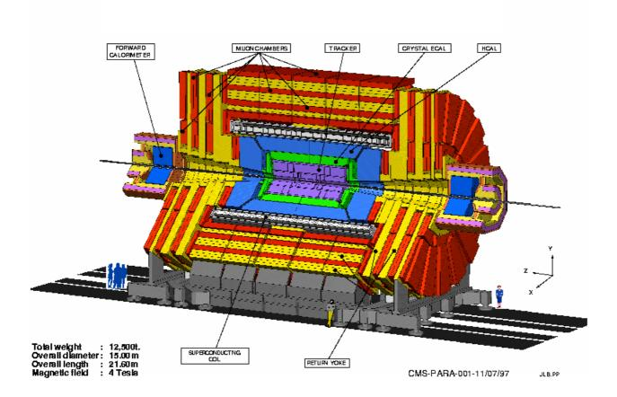
Length : 20 m Radius : 7 m Weight : 14000 tons Electronics channels : 10<sup>8</sup>
