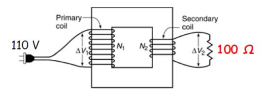
$$\Delta V_2|_{rms} = 10(110V|_{rms}) = 1100V|_{rms}$$
